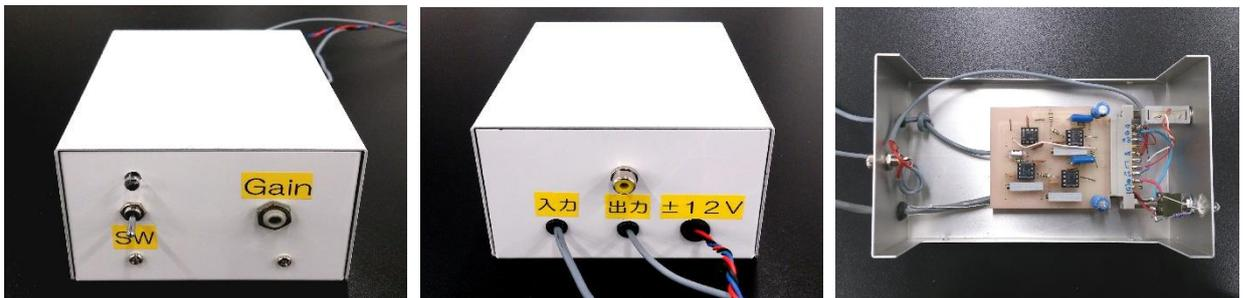
用いる増幅器（左：表のスイッチパネル、中：入力、出力、電源リード線、右：内部の構造）
