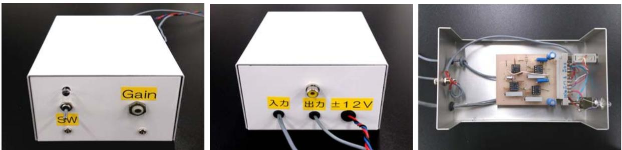
用いる増幅器（左：表のスイッチパネル、中：入力、出力、電源リード線、右：内部の構造）
